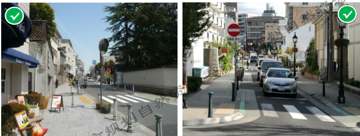
图5-14 适宜的阻车桩样式和高度
