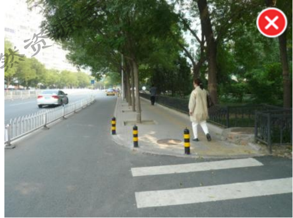
图5-16 阻车桩高度过低（40cm）
